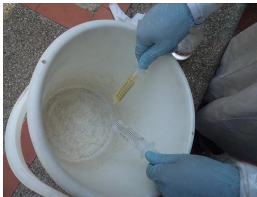
a) Medición del volumen de resina y endurecedor.
