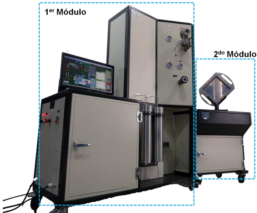
Figura 38. Equipo de Desplazamiento Radial
