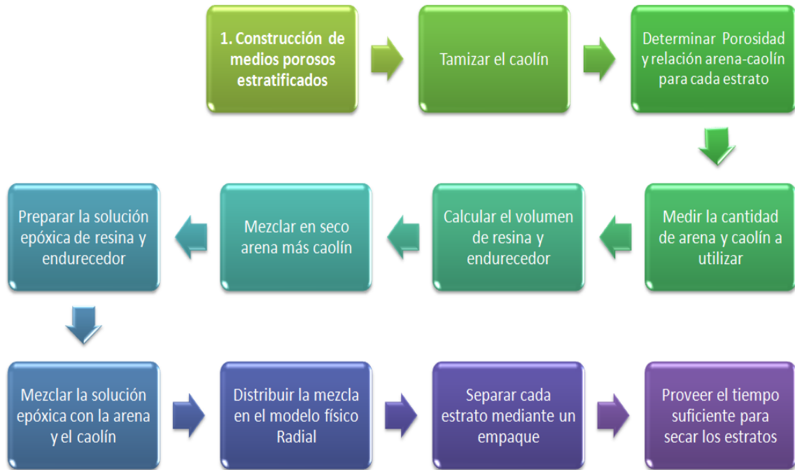
Figura 23. Procedimiento para la construcción de medios porosos estratificados.
