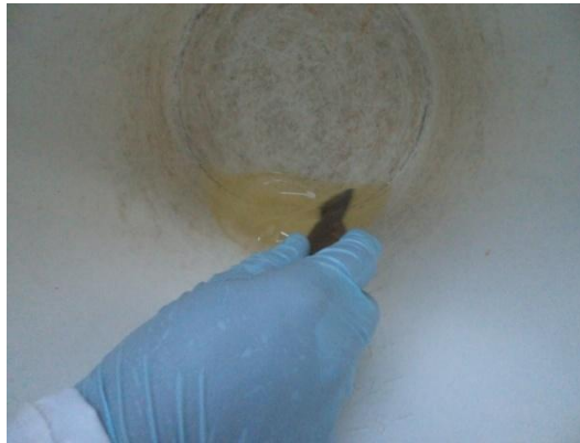
b) Mezcla de la resina y el endurecedor.
