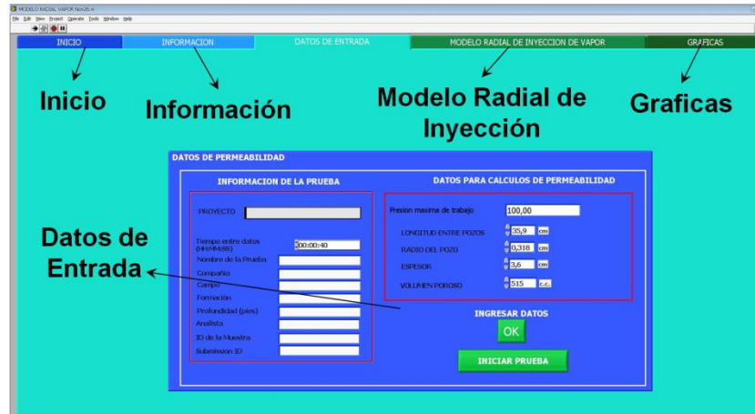
Figura 49. Panel frontal del E.D.R y pestaña datos de entrada
