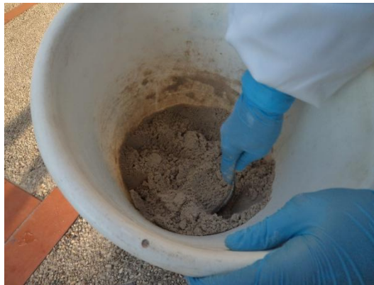
Figura 31. Mezcla de la arena y el caolín más la solución epóxica.
