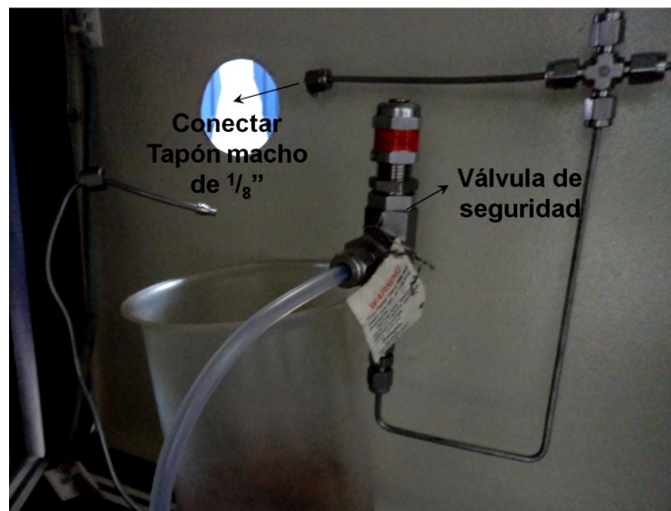
Figura 59. Conexión para taponar la línea de producción
