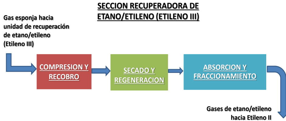
Figura 3. Diagrama de bloque sección de recuperación de etano/etileno (Etileno III)
