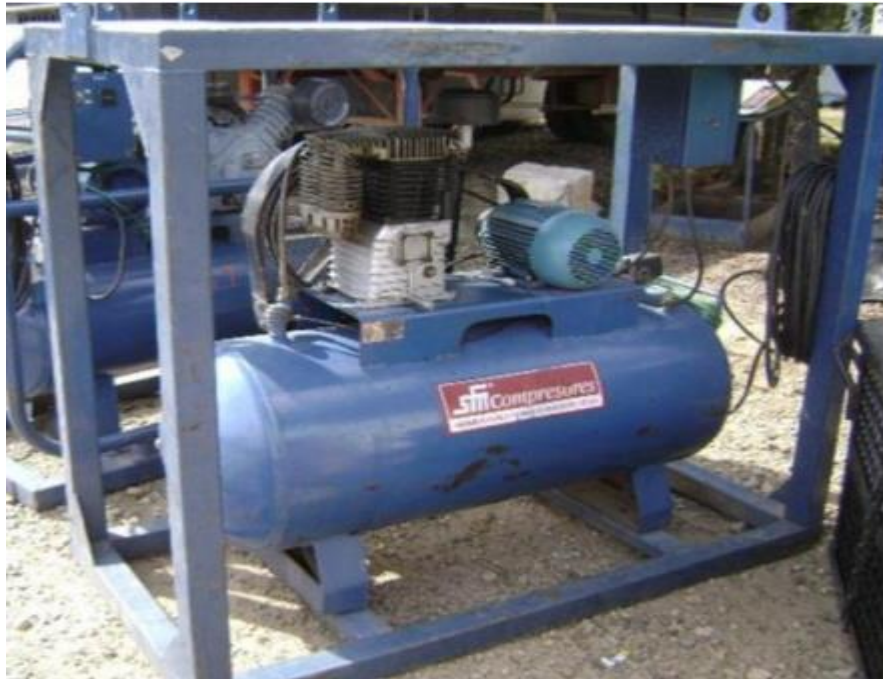
Figura 7. Compresor de aire comprimido
