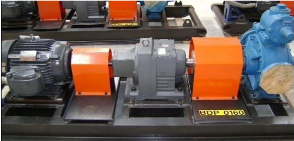
Figura 6. Bomba de desplazamiento positivo tipo paletas
