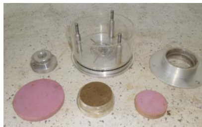
GRÁFICA 4. Elementos de célula edométrica con muestra en la anilla.
