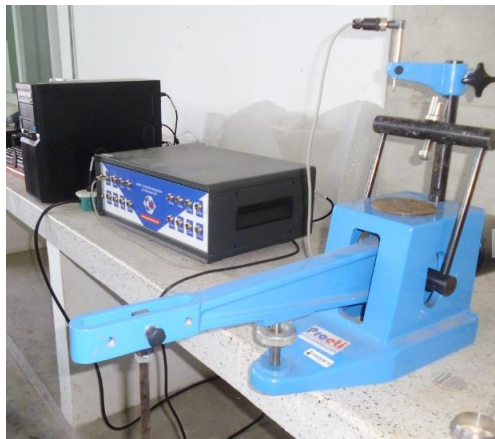
GRÁFICA 5. Edómetro de carga central, unidad de adquisición de datos, ordenador.
