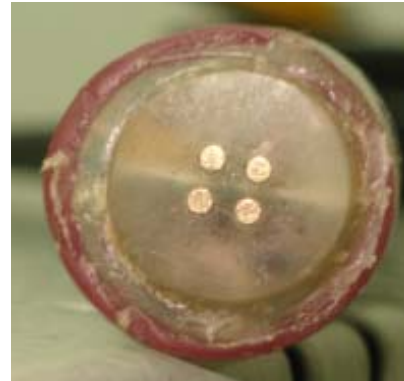
Figura 19. Diseño geométrico de la sonda de medición con electrodos (Au).
