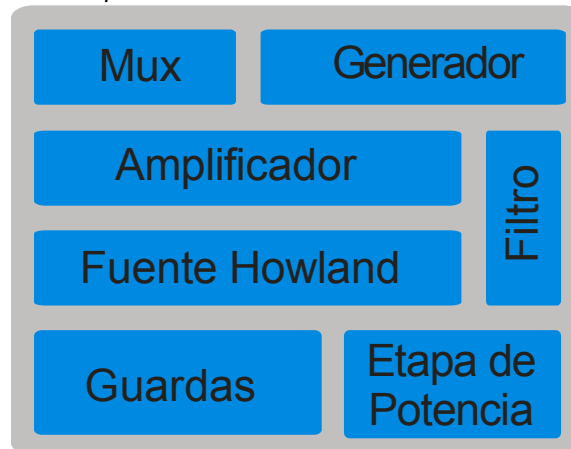
Figura 35. Distribución de bloques de la PCB diseñado.
