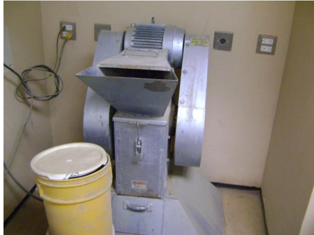
Figura 41. Trituradora utilizada en la preparación de las muestras
