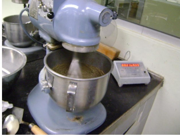
Figura 45. Mezcladora en funcionamiento durante la etapa de preparación del mortero
