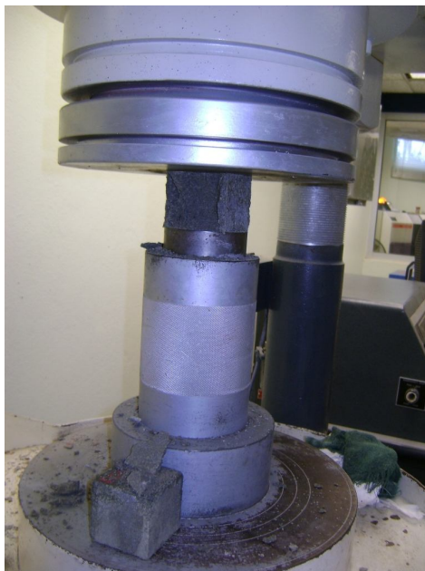
Figura 50. Proceso de ruptura de un cubo en la Máquina de compresión
