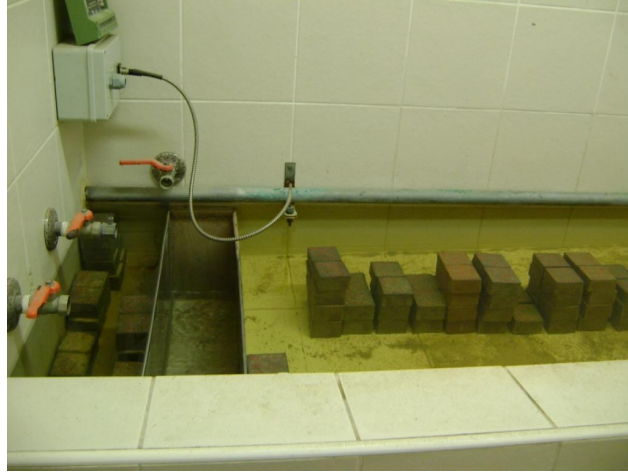
Figura 49. Tanque de almacenamiento de los cubos en el cuarto de curado
