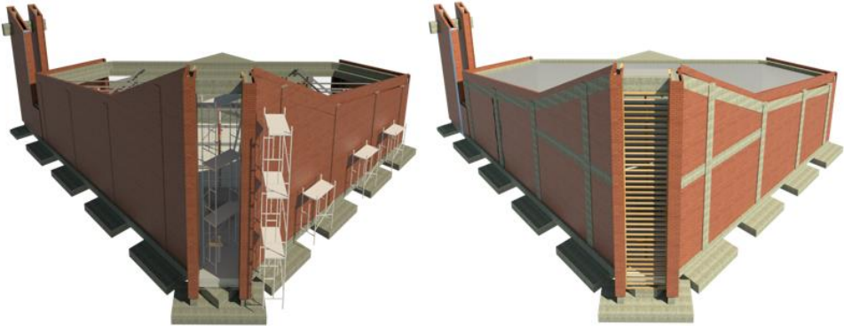
Ilustración 29. Modelado antes y después del reforzamiento, vista posterior.
