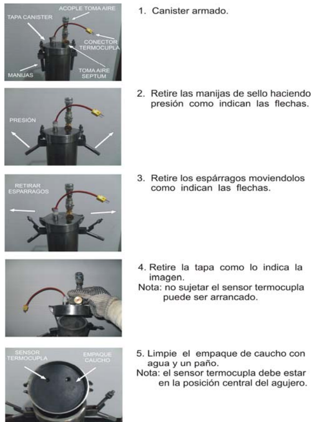
Figura 9. Desacople de la tapa.
