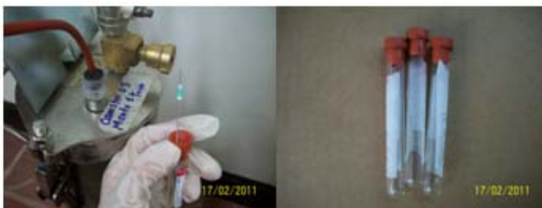
Figura 13.Toma de muestra de gas en tubo vacutainers
