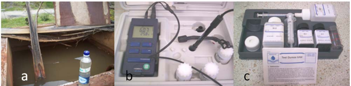
Figura 16 . a) Estanque donde se recogió una muestra de agua, b) Equipo de medición de pH, c) Kit de medición de dureza total.
