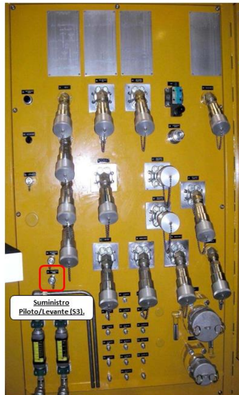
Figura 24. Acople del circuito Piloto/Levante.
