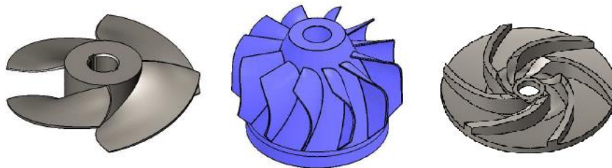
Figura 2. Modelo CAD del impulsor de diferentes tipos de bombas rotodinámicas: axial (izq.), mixta (cent.) y radial (der.)
