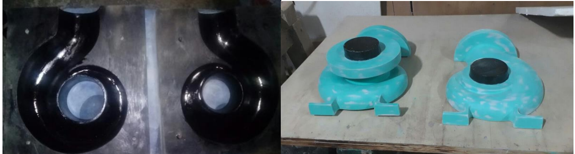
Figura 49. Juego de modelos para la voluta: cavidad interna(izq.) y externa(der.)
