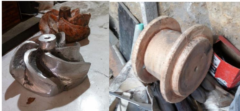
Figura 48. Modelo del impulsor y fundición de aluminio (izq.) modelo de la cubierta trasera (der.)
