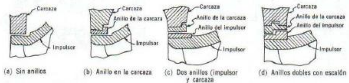
Figura 7. Tipos de anillos de desgaste
