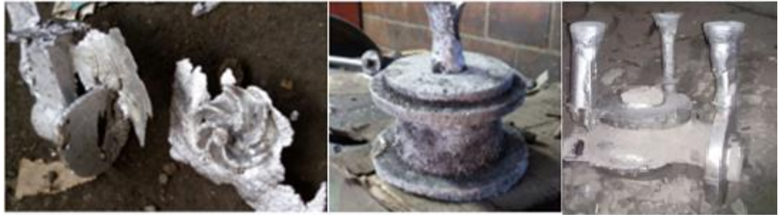
Figura 50. Piezas fundidas: alojamiento (izq.), impulsor (med.), cubierta trasera (der.)
