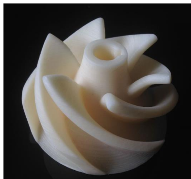
Figura 51. Impulsor impreso en ABS
