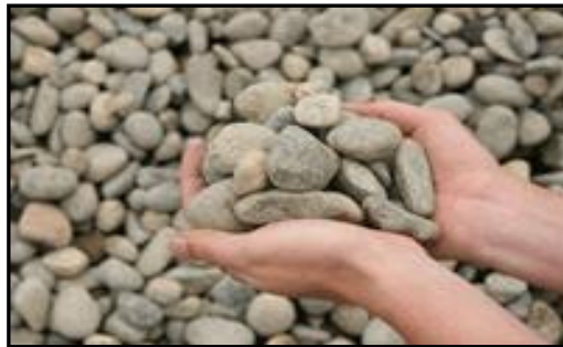
Figura 11.5. Detalle del material granular del Medio Filtrante
