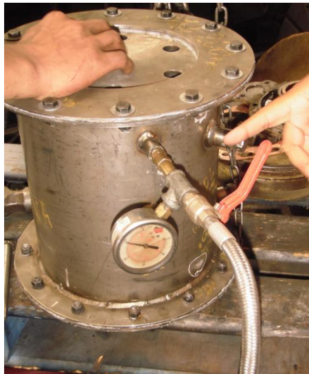
Figura 86. Prueba hidrostática a 120 psi
