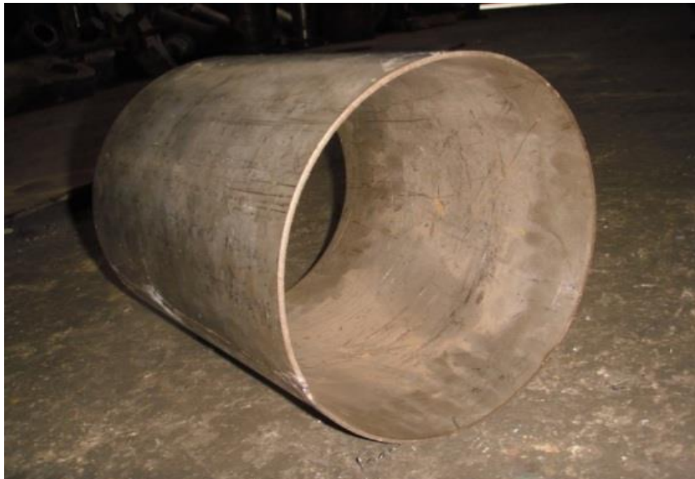
Figura 57. Casco doblado y soldado
