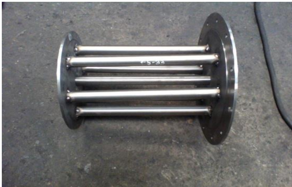
Figura 58. Tubos de combustión
