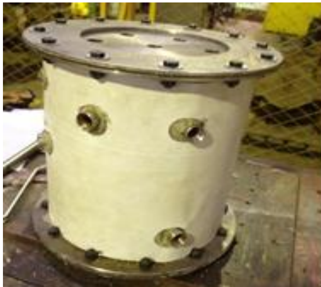
Figura 63. Caldera cubierta con lámina de acero
