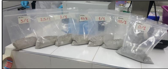
Figura 17. Muestras de ripios de cemento en tamaño de grano
