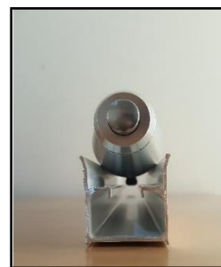
Figura 11. Martillo Schmidt tipo L y soporte para disparo perpendicular. (vista frontal)
