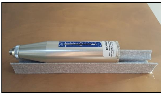
Figura 10. Martillo Schmidt tipo L y soporte para disparo perpendicular (vista lateral)
