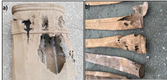
Figura 4. Mangas quemadas por partículas incandescentes. a) Parte inferior de la manga con quemaduras. b) Mangas con presencia de quemaduras en la misma área.
