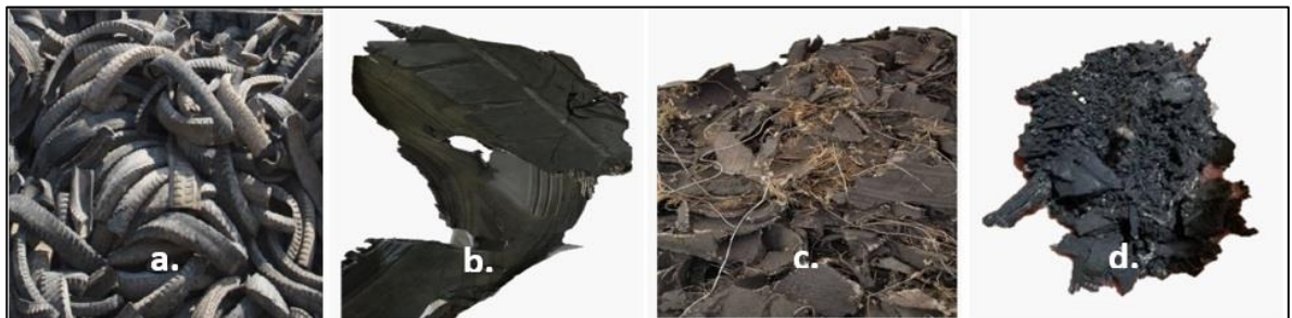
Figura 2. a) Neumáticos enteros. b) Tamaño TDF de grano grueso. c) Tamaño TDF de grano mediano. d) Tamaño TDF de grano polvo.
