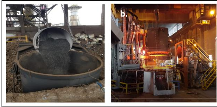
Figura 8. a) Cesta cargada con TDF. b) Descargue del primer cargue.
