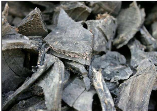
Figura 7. Trozos de TDF con el tamaño aceptable
