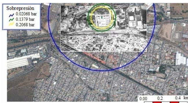
Figura 17. Contornos de sobrepresión sobre las instalaciones de PEMEX.
