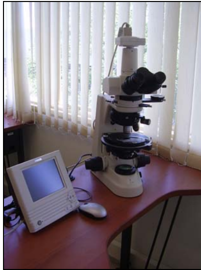
FIGURA 1 Aspecto del microscopio de luz transmitida marca NIKON, utilizado en el presente estudio. Laboratorio de Microscopía de la Escuela de Geología. UIS.
