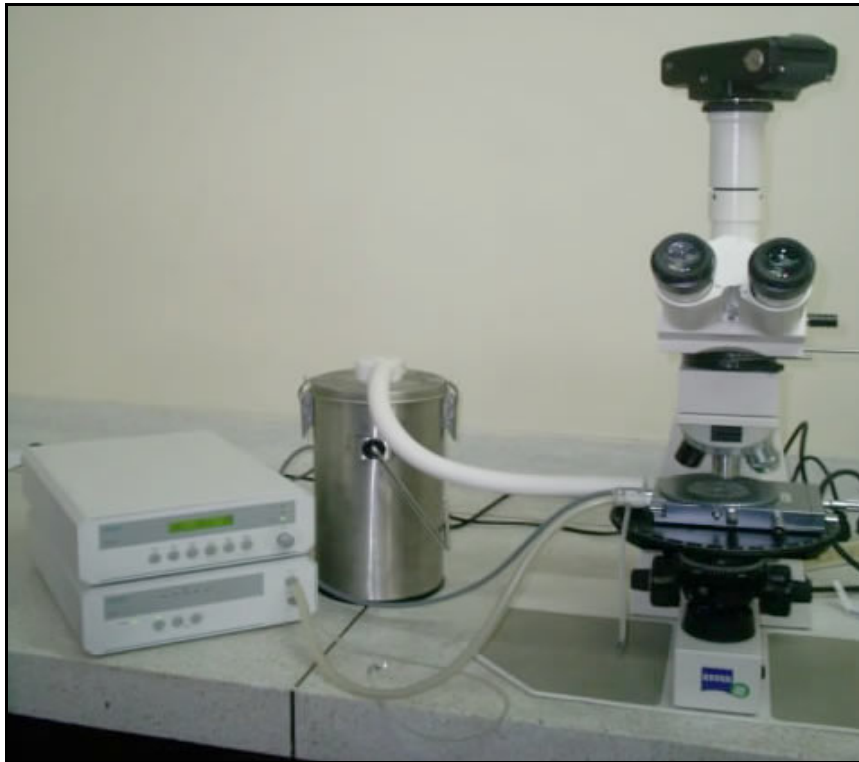
FIGURA 3 Aspecto del equipo para análisis de Inclusiones Fluidas del laboratorio de microtermometría en la sede UIS-Guatiguará (Piedecuesta, Santander).
