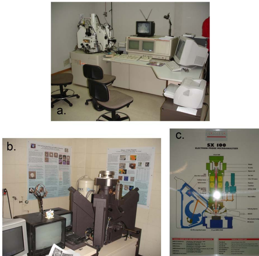
FIGURA 2 Aspecto de las Microsondas electrónicas, utilizadas en el presente estudio para análisis de química mineral. Microsonda JEOL del Centro de Microscopía Electrónica Luís Bru (Madrid, España) 2a. Microsonda Cameca MBX del Electrón Microprobe Laboratory en Arizona University (Tucson, Arizona, EE.UU) 2b. Esquema ilustrativo de los componentes de la microsonda Cameca 2c.
