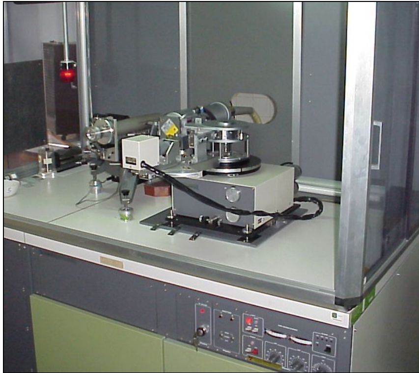
FIGURA 4 Aspecto del Difractómetro marca RIGAKU modelo D/MAX IIIB utilizado en el presente estudio. Laboratorio de DRX de la Escuela de Química de la UIS.
