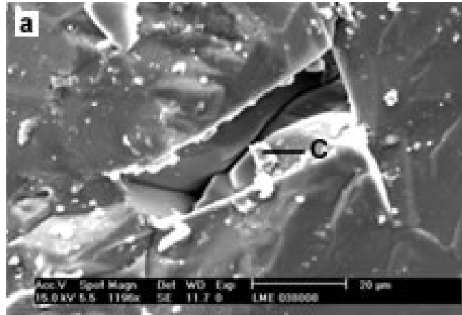
FIGURA 49 Imágenes del SEM de cavidades de inclusiones con sólidos. a- Microfotografía SEM de cristal hijo de calcita (C) en la muestra LME038008.
