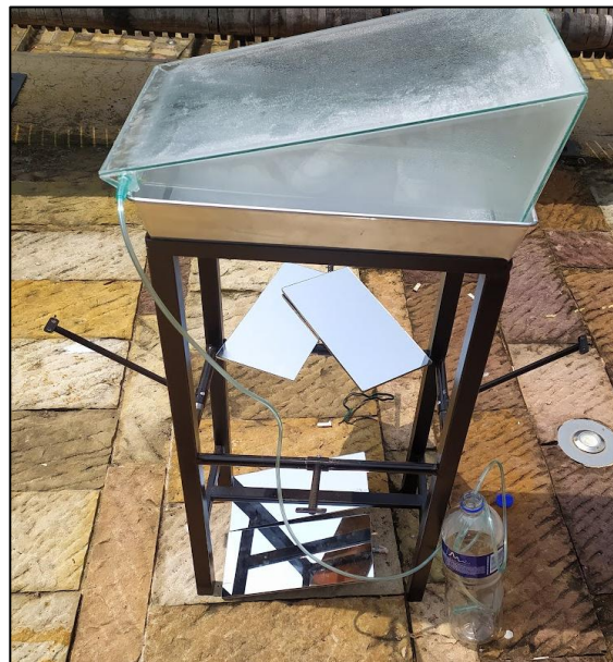
Figura 14. Montaje del prototipo potabilizador
