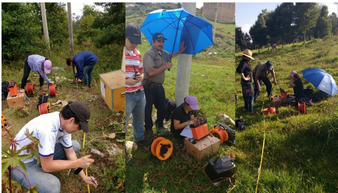
Figura 19. Adquisición y puesta de arreglo geométrico Schlumberger.
