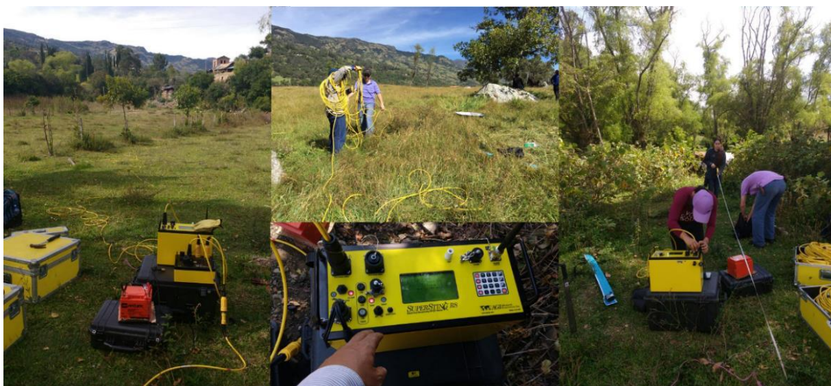
Figura 24. Equipo de campo realizando labores de toma de datos por medio del equipo Supersting R8.
