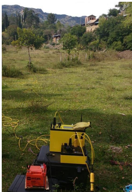
Figura 28. Batería, CPU y Swichbox del equipo.
