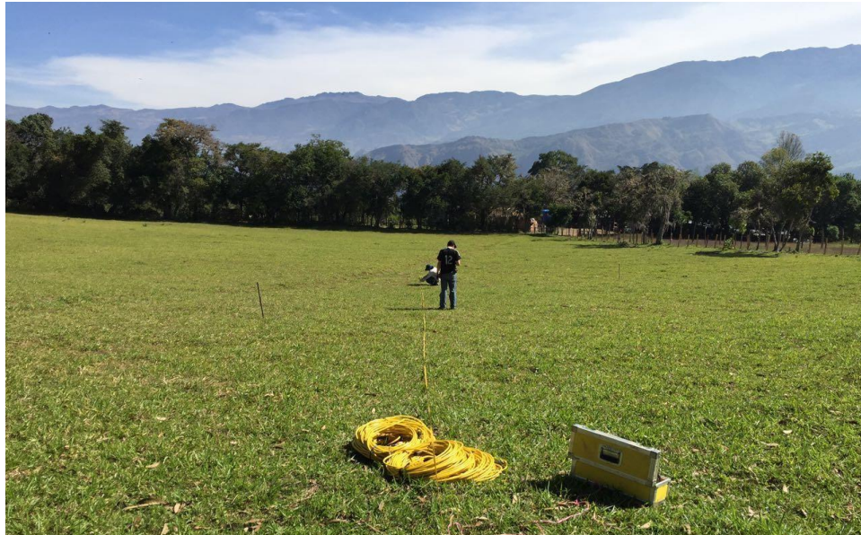
Figura 25. Cableado utilizado por el equipo supersting R8.
