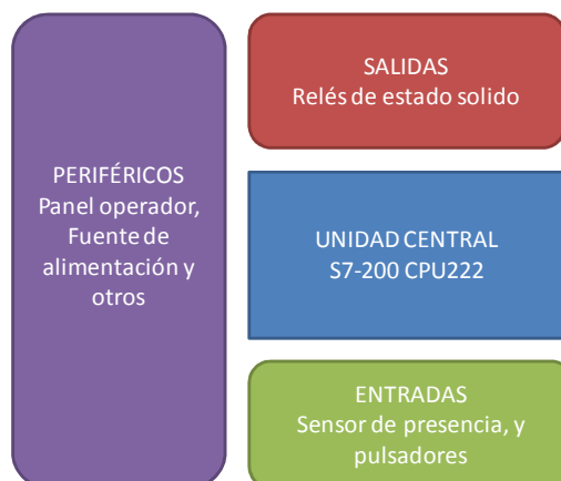
Figura 52 Arquitectura sistema domótico
