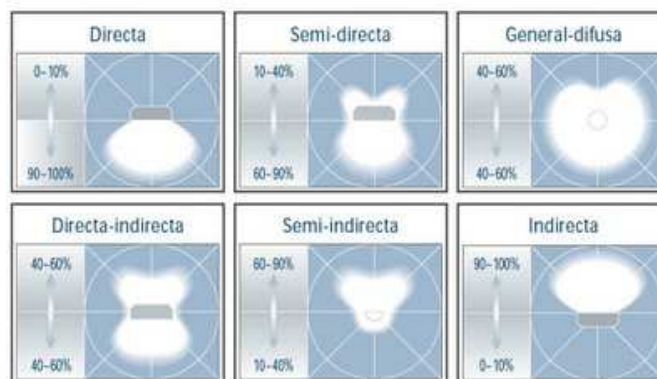
Figura 7 Clasificación por flujo luminoso
