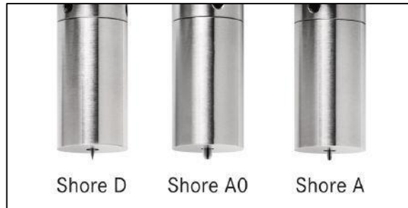
Figura 13. Clases de indentadores Shore.
