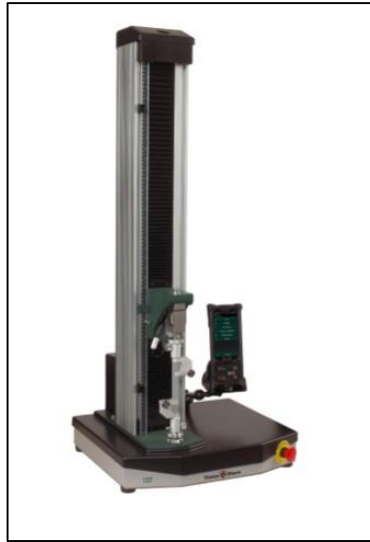
Figura 23. Máquina Universal de Ensayos Tinitus Olsen.
