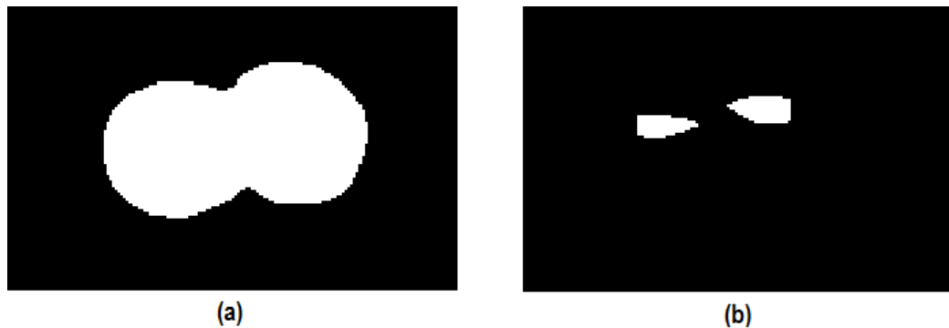
Figura 29. (a) Componente conexo. (b) Erosión para separar el componente conexo.
