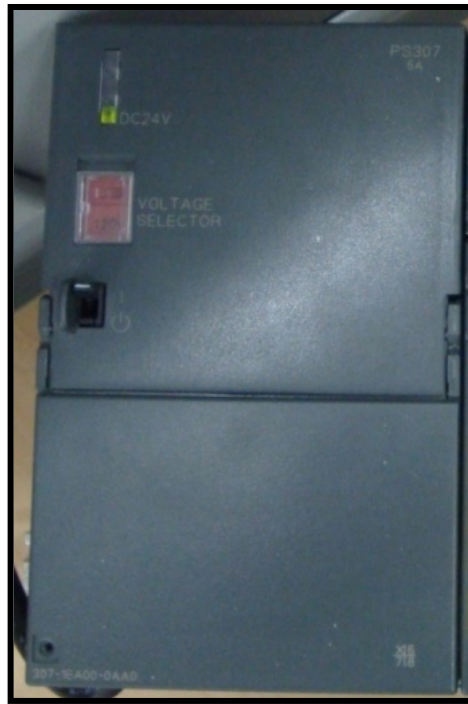
Figura 60. Fuente de poder (PS) de 5 amperios.
