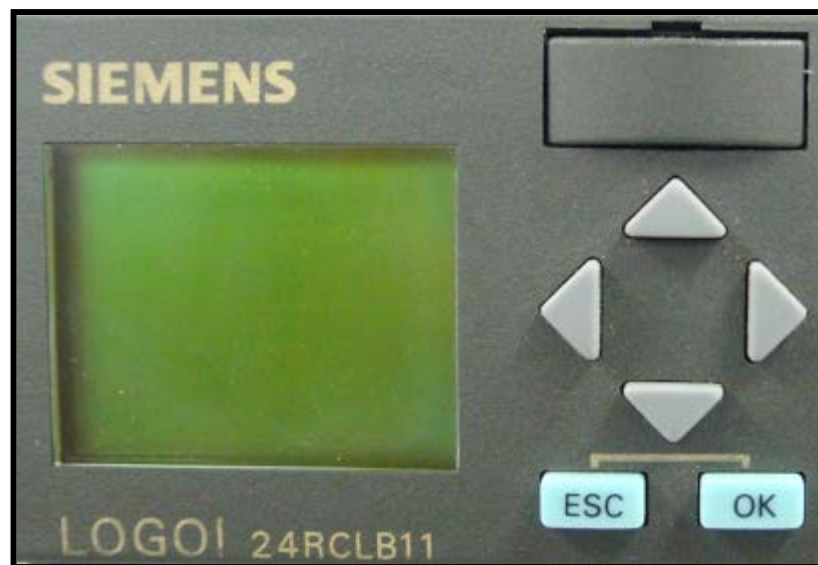
Figura 30. Panel del módulo lógico LOGO!.
