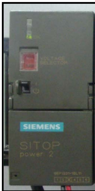
Figura 51. Fuente de poder PS de 2 amperios
