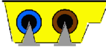
Figura 49. Forma de contacto al cable AS-i.
