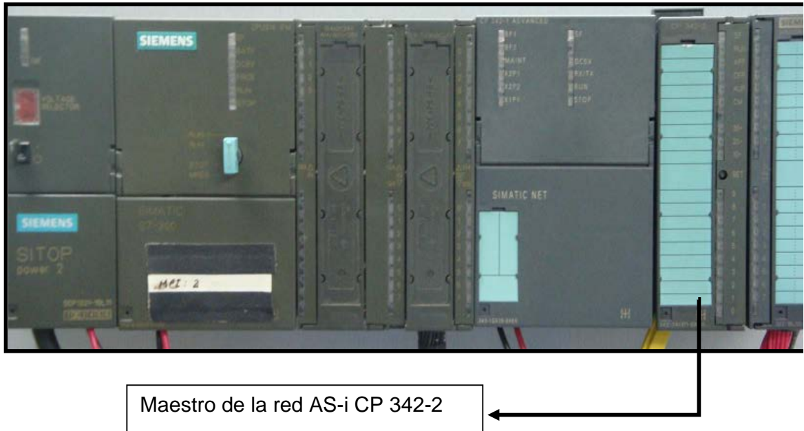
Figura 54. Controlador S7 300(2) con maestro AS-i.
