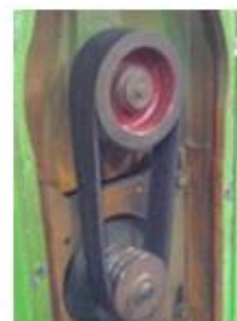
Sistema de transmisión de potencia por banda
