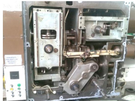
Sistema de transmisión de potencia al husillo
