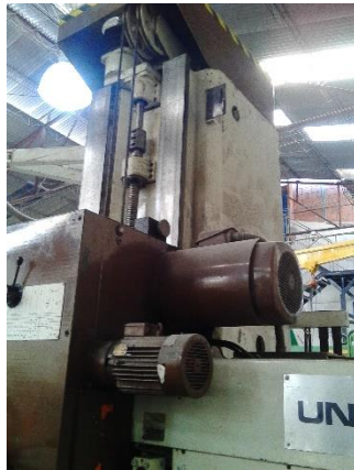
Sistema de transmisión de potencia a los 3 ejes de la mesa
