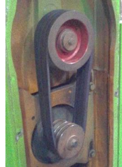
Sistema de transmisión de potencia al husillo
