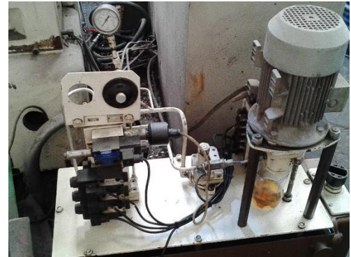
Sistema de transmisión de potencia al husillo
