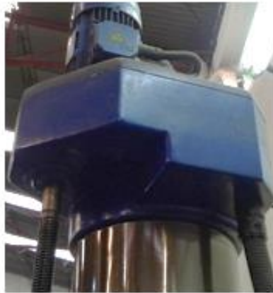
Sistema de ascenso y descenso del brazo horizontal
