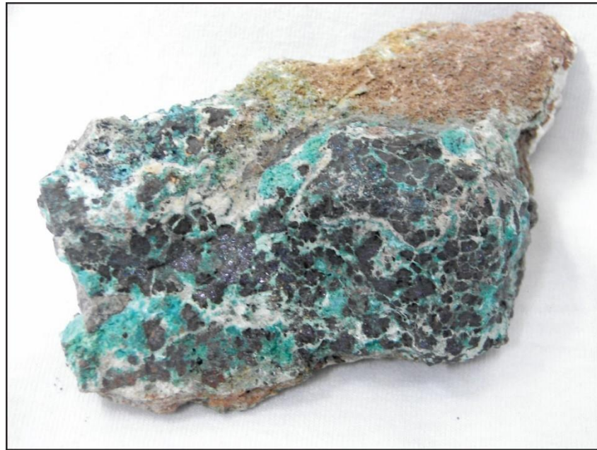
Figura 45. Muestra de la zona mineralizada de la Mina Camperucho, presencia de bornita, calcopirita, pirita, covelita, calcosina, malaquita, azulita, barita).
