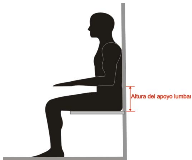
Imagen 20. Altura del apoyo lumbar posición sedente
