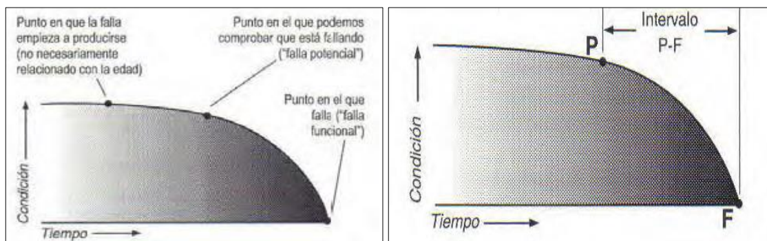
Figura 21. Curva e intervalo P-F
