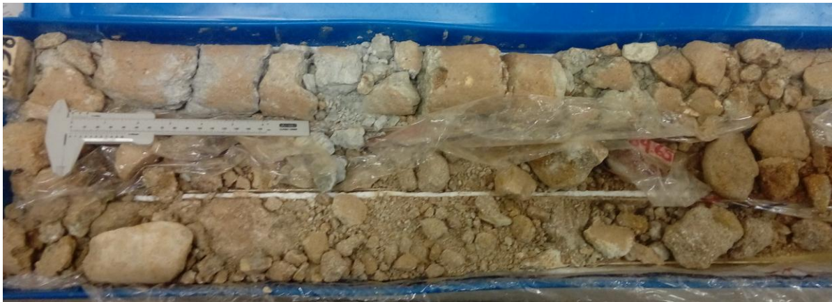
Figura 7. Ejemplo del nivel de meteorización de los sondeos que no fueron seleccionados.
