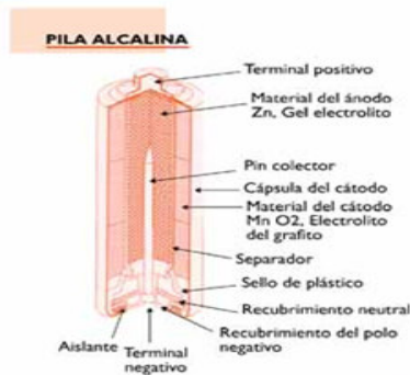
Figura 3. Esquema de la pila alcalina
