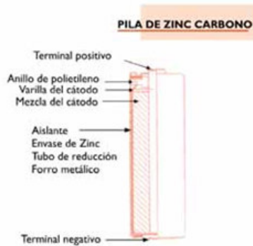
Figura 2. Esquema de la pila de Zinc
