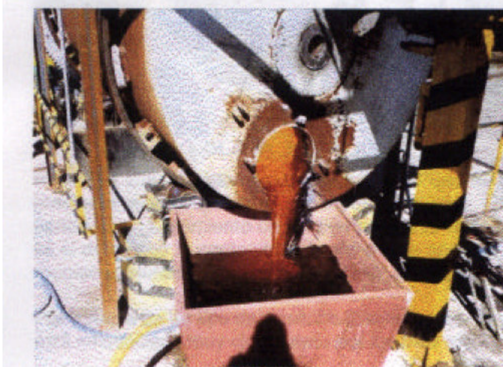
Figura 16 Salida del horno del material vitrificado planta IDM
