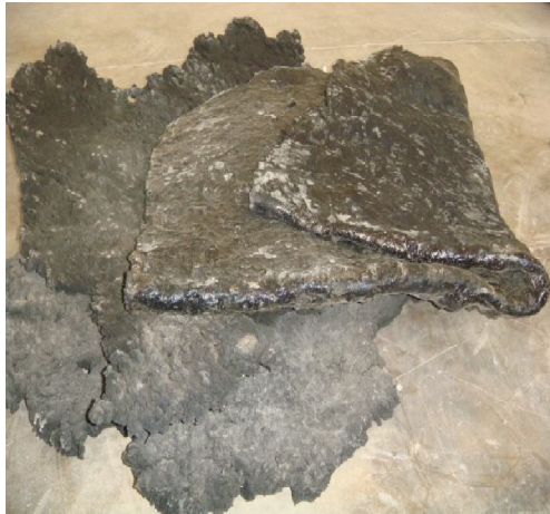
Figura 3: Caucho parcialmente vulcanizado
