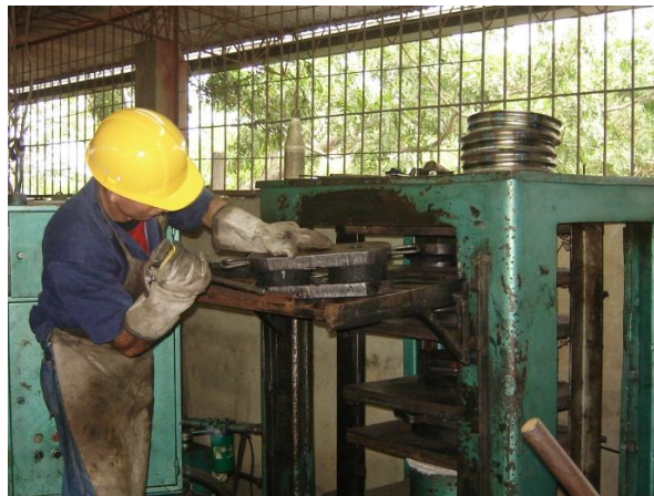
Figura 15. Proceso de vulcanizado
