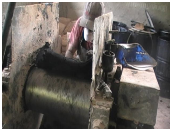
Figura 13. Fabricación caucho grasoso
