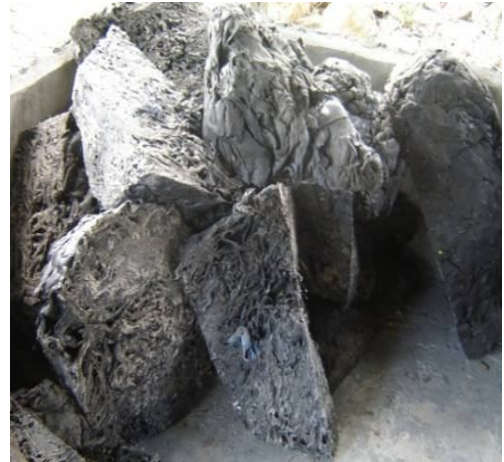
Figura 3: Caucho parcialmente vulcanizado
