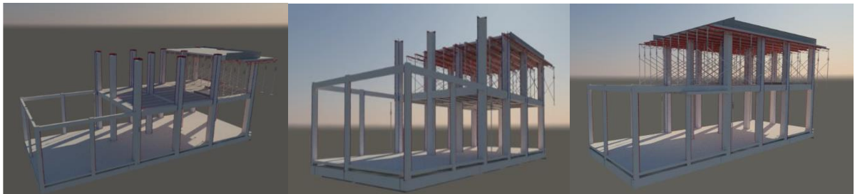
Figura 29. Simulación del modelo BIM 5D, proceso constructivo de la estructura en el software Autodesk Naviswork Manage 2017.
