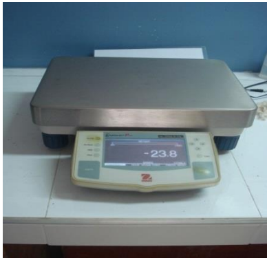
Balanza digital Explorer (Indispensable en la realización de análisis granulométrico)
