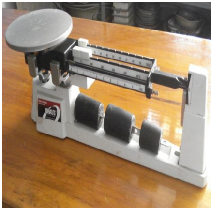
Balanza mecánica OHAUS (Indispensable en la realización de análisis de suelos)
