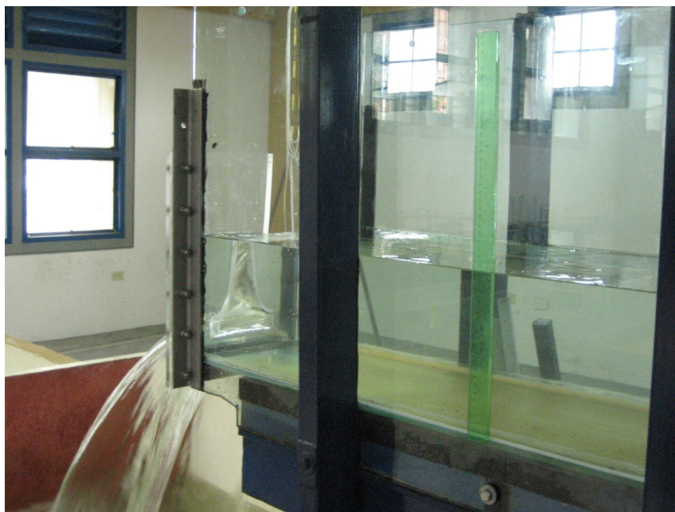
Foto 19 – Funcionamiento y calibración de vertedero proporcional sutro.
