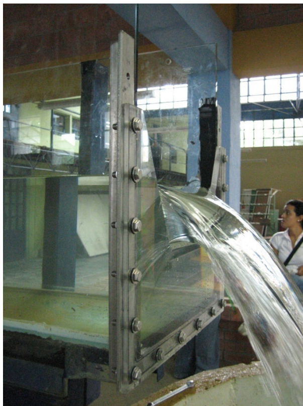
Foto 18 – Funcionamiento del vertedero trapezoidal.
