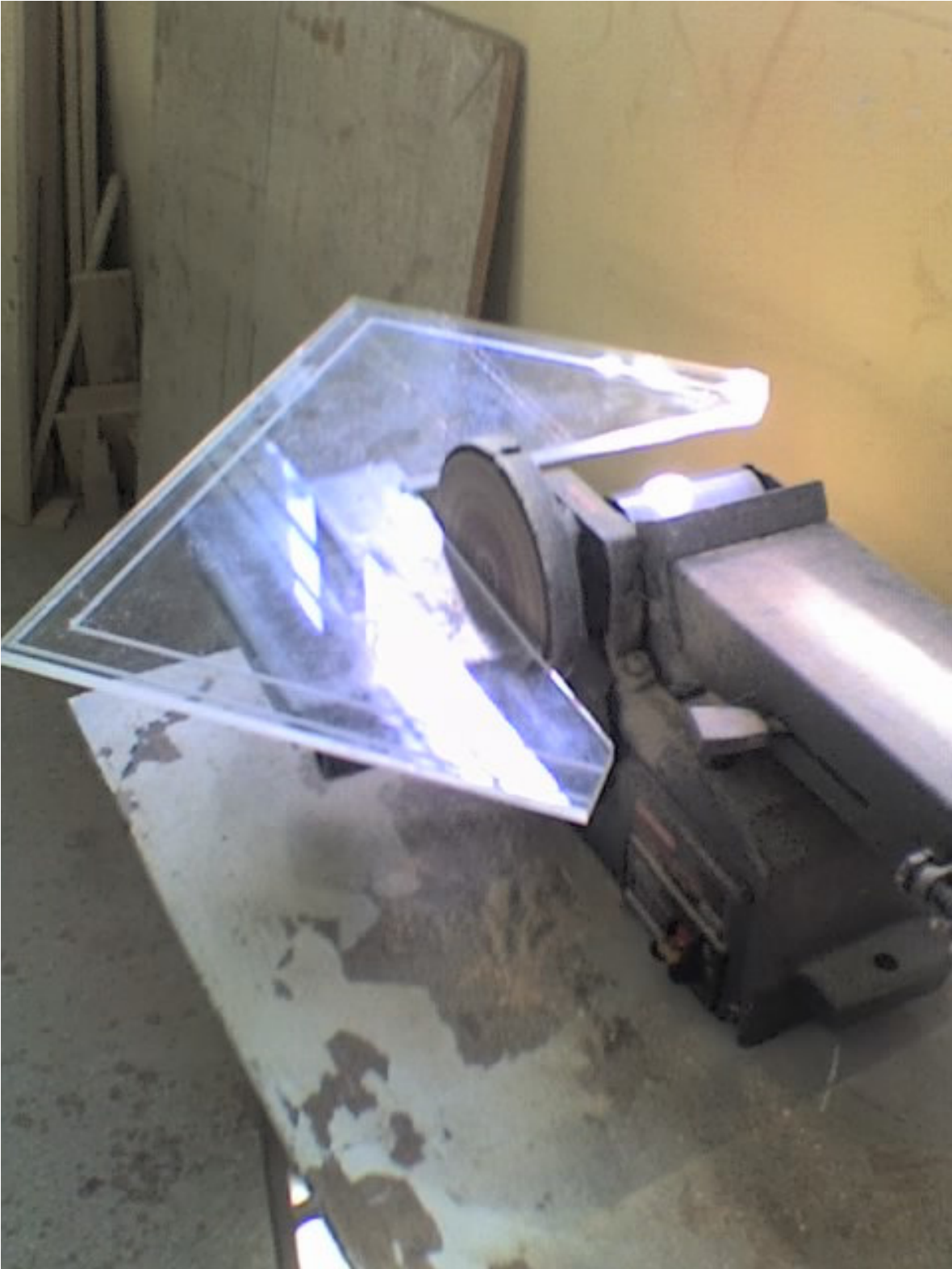
Foto 9 – Construcción de vertederos. Lijado de la cresta del vertedero.
