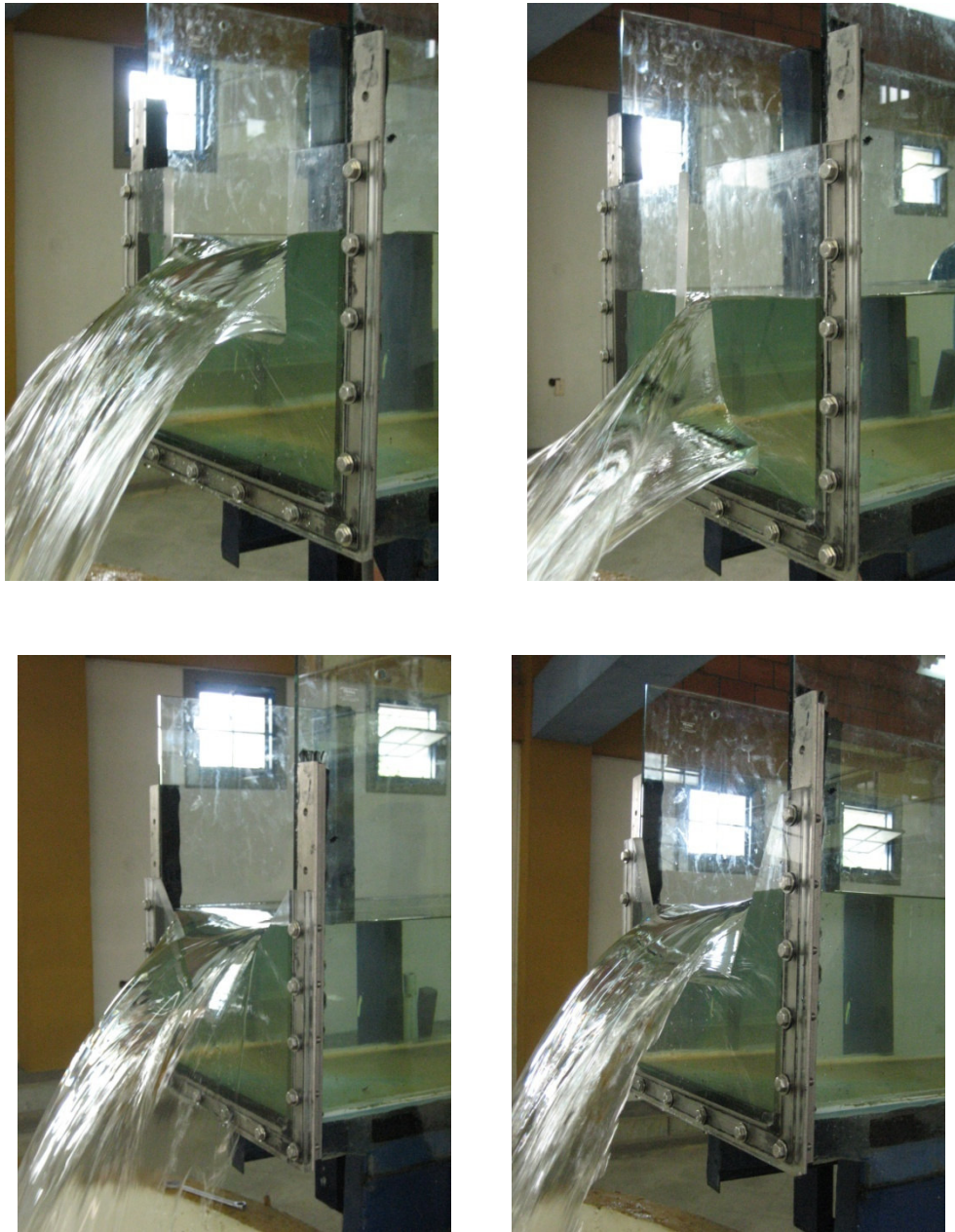
Fig. 4 – Vertederos de cresta aguda instalados en el canal de vidrio.
