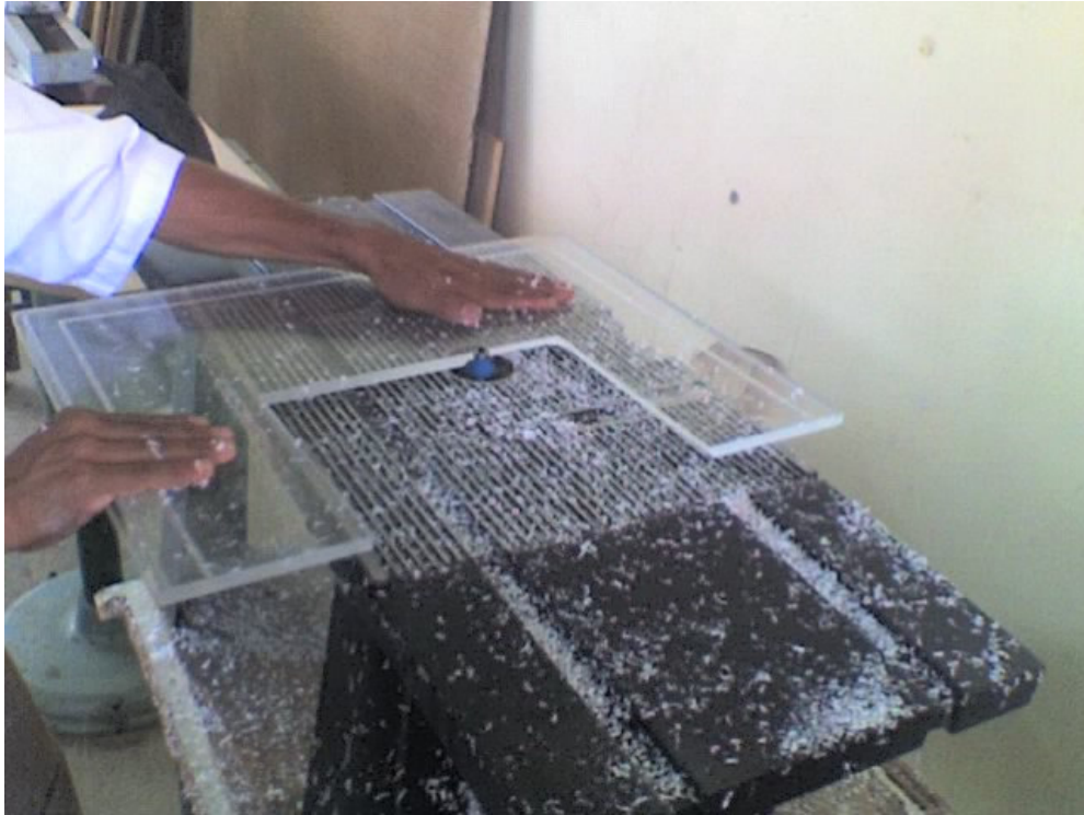
Foto 10 – Construcción de vertederos. Biselado de la cresta del vertedero.
