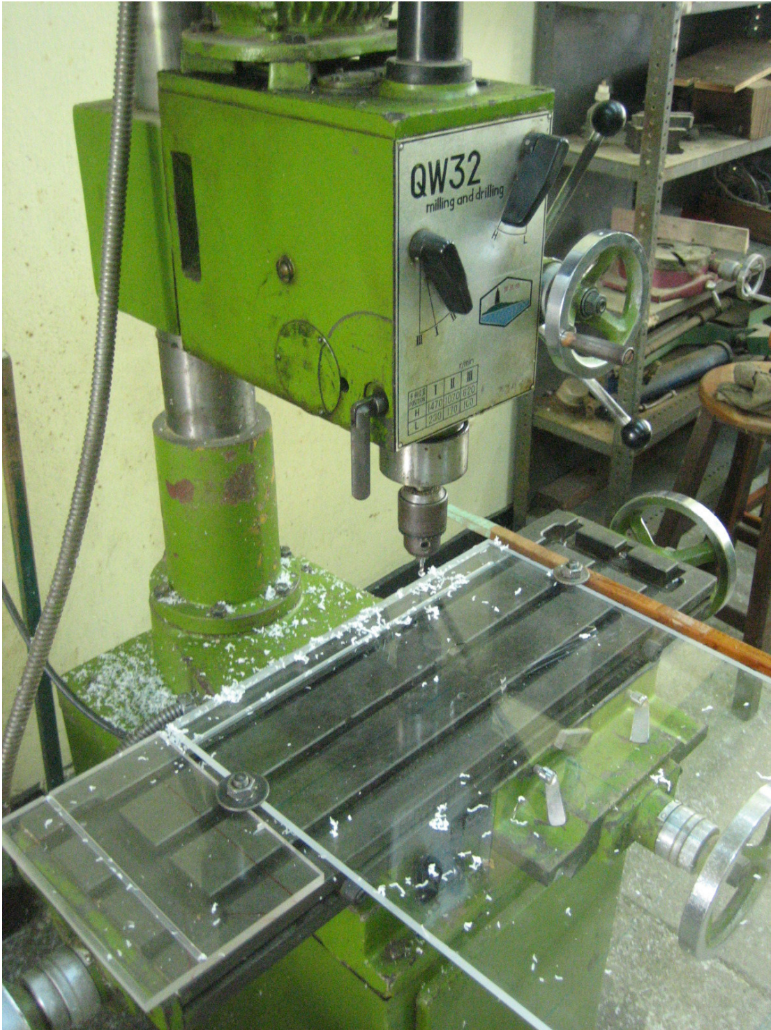
Foto 7 – Construcción de vertederos. Elaboración de ranuras para los O-Rings.
