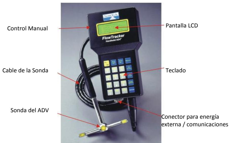
Fig. 1.1 – Partes del ADV
