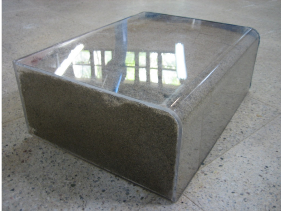
Foto 5 – Obstáculos para el canal. Obstáculo rectangular con arista redondeada.
