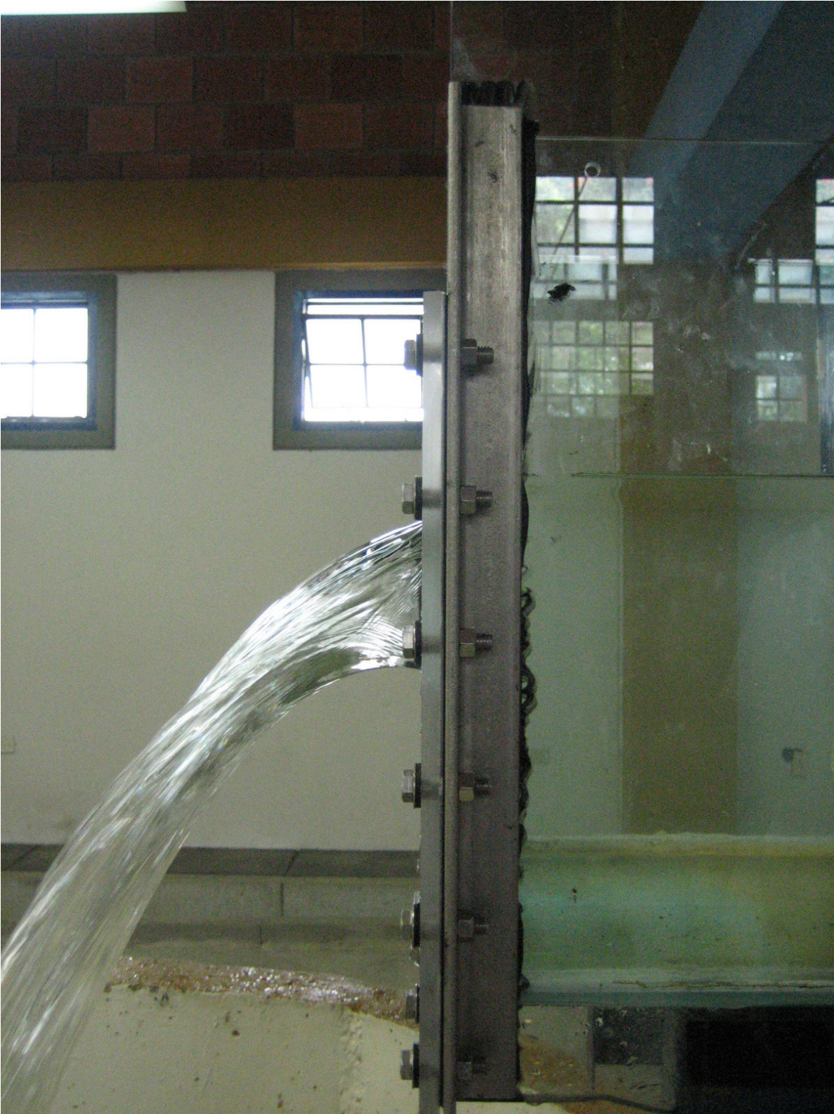
Foto 19 – Funcionamiento del vertedero de cresta aguda. Detalle de la descarga.
