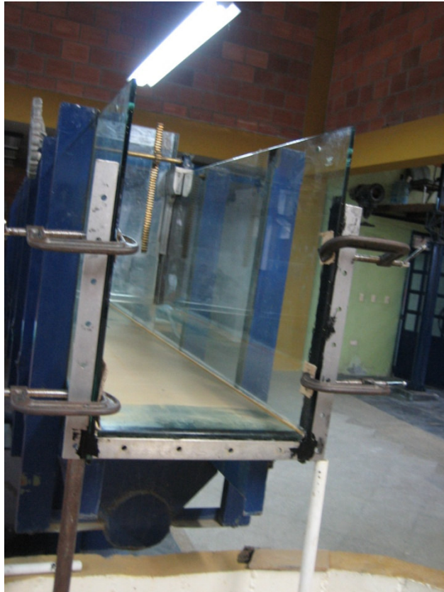
Foto 3 – Instalación de perfiles. Perfiles sujetos al canal de vidrio.
