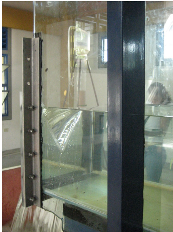
Foto 17 – Funcionamiento del vertedero triangular.
