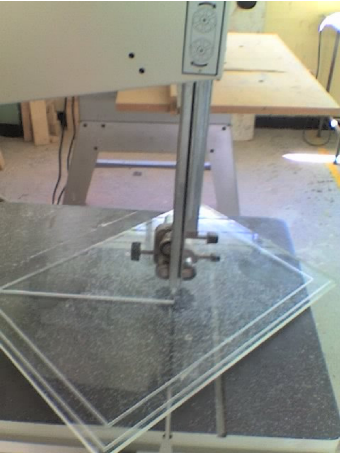
Foto 8 – Construcción de vertederos. Corte de la forma para las crestas de los vertederos.
