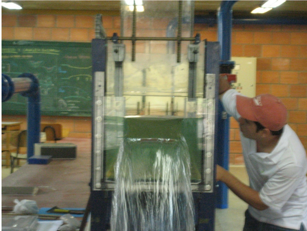
Foto 16 – Funcionamiento y calibración de vertedero rectangular contraído.
