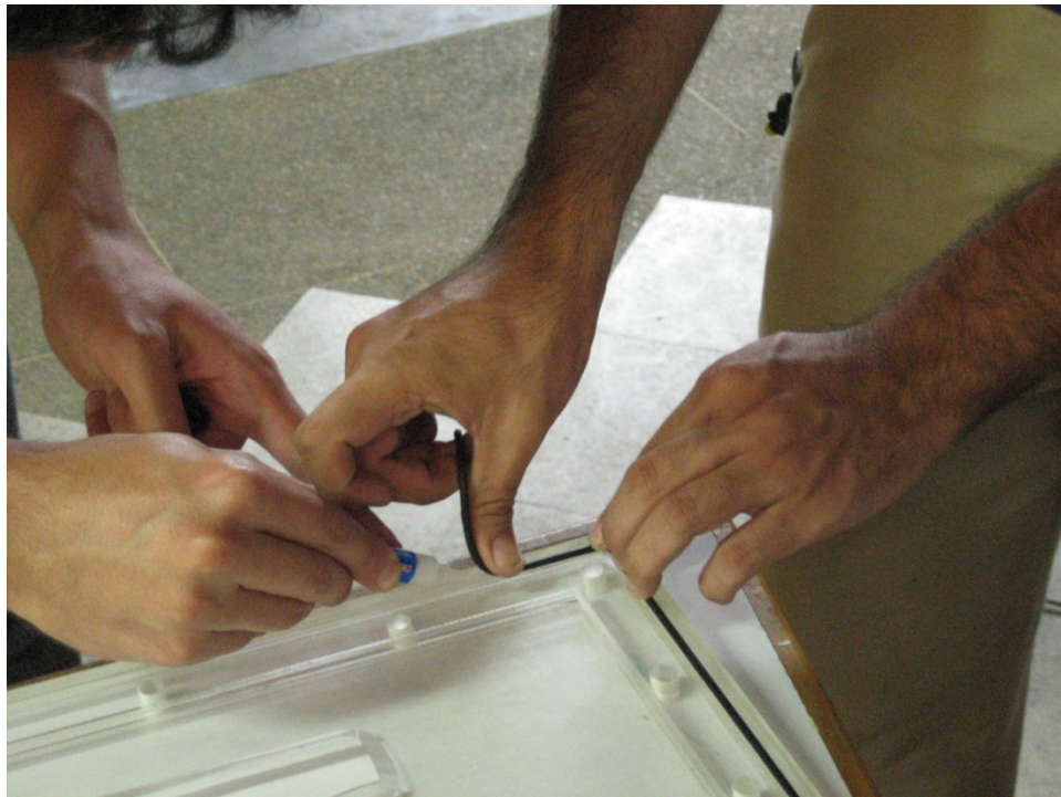
Foto 13 – Construcción de vertederos. Detalle instalación de O-rings de 3.5mm.
