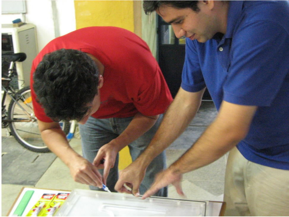
Foto 12 – Construcción de vertederos. Instalación de los O-rings de 3.5mm.
