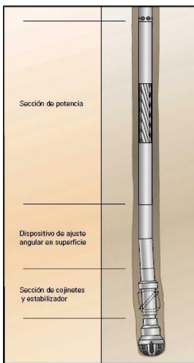
Figura 1. Bottom hole assamble (BHA). Adaptado de Schlumberger. (2009). Evolución de la tecnología de perforación direccional. La comunidad petrolera Sitio web: https://goo.gl/75ZDN3
