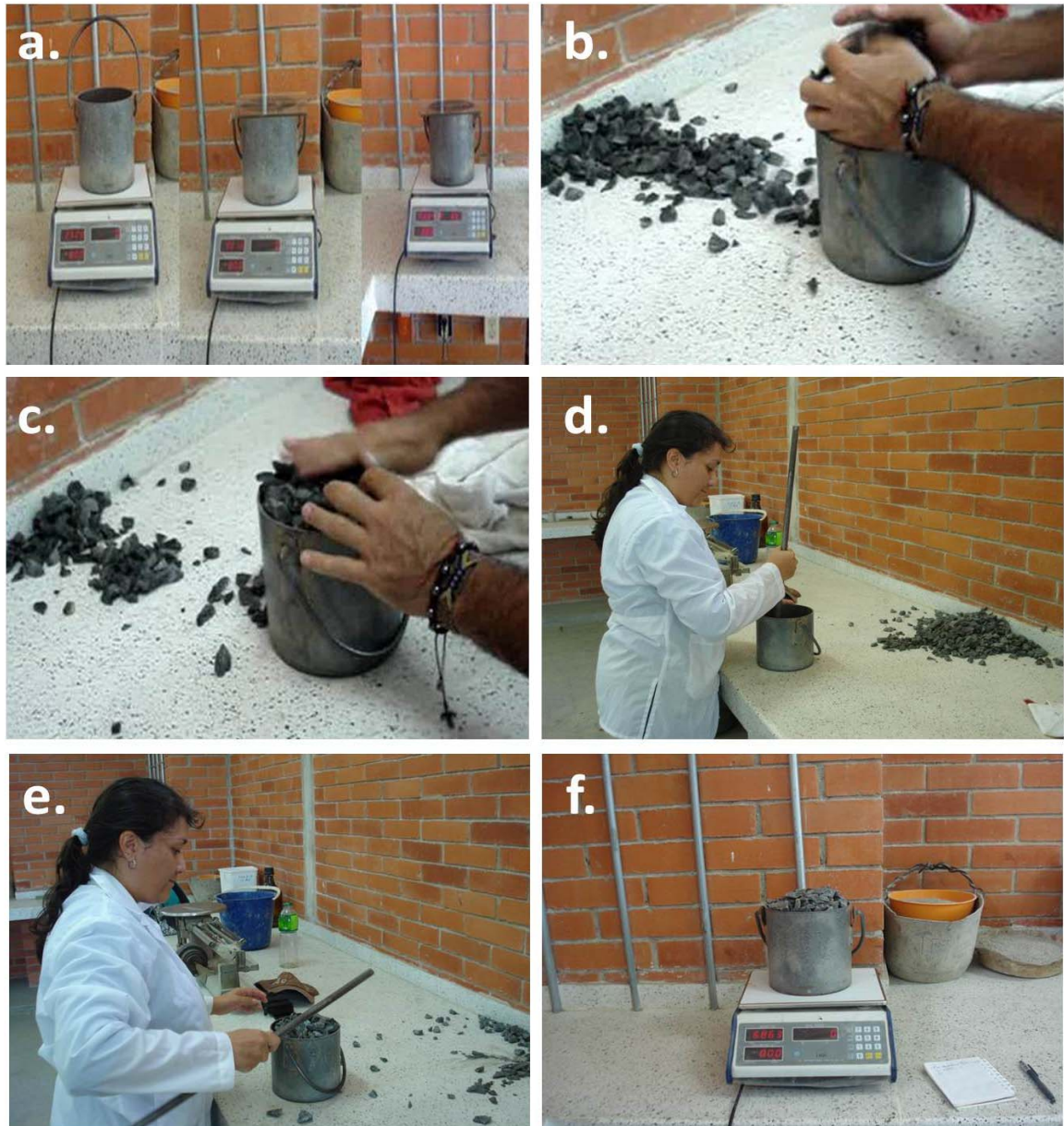
Figura 6. a) Peso del medidor vacío, del medidor vacío con vidrio y peso del medidor con agua y vidrio. b) y c) Método suelto para determinar peso unitario. d) y e) Método de apisonado para determinar peso unitario. f) Se pesa cada tipo de roca triturada tres veces y se saca promedio.
