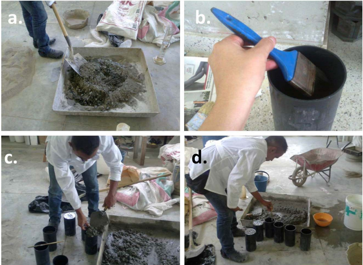
Figura 13. a) Se observa la mezcla de la arena, agregado y agua con el cemento. b) Los moldes de PVC son cubiertos con ACPM. c) y d) Llenado de los moldes. e) Los moldes se dejan en un lugar seco y plano para su curado de un día. f) Se ajustan los cilindros a la máquina. g) Se inicia el proceso de compresión. h) Todos los cilindros ensayados.
