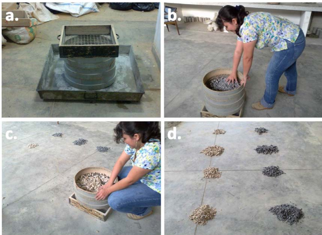
Figura 5. a) Tamices 1", 3/4", 3/8", No4, No 8 en forma descendente. b) y c) Proceso de tamizado para cada muestra. c) Material retenido en cada tamiz.
