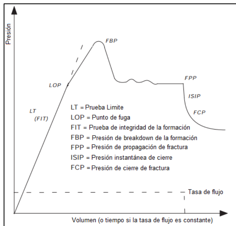
Figura 8: Esquema de una prueba de fuga extendida.
