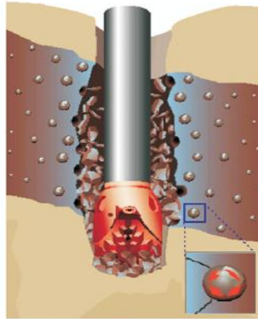
Figura 27: Perforación a través de un shale inducido a sobrepresiones.
