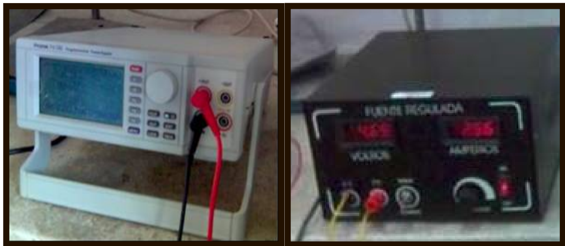
Figura 6.12. Fuentes usadas para el suministro de voltaje y corriente, en los montajes realizados para el proceso de electropulido, a) Protek 6100 y b) Fuente Reguladora
