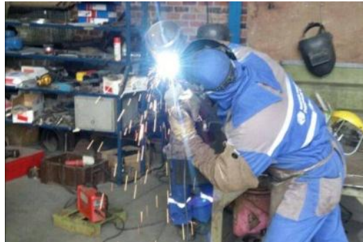
Figura 13. Foto de soldadura con proceso SMAW en posición 6G ascendente.
