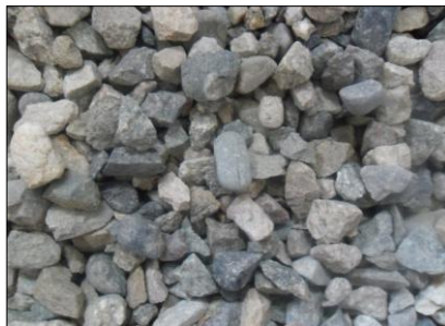
Fotografía 20 Muestra para ensayo de Caras fracturadas
