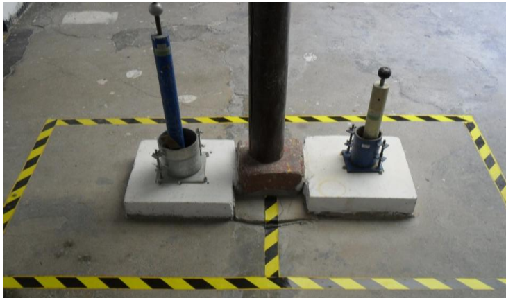
Fotografía 3 Equipo para ensayo de compactación
