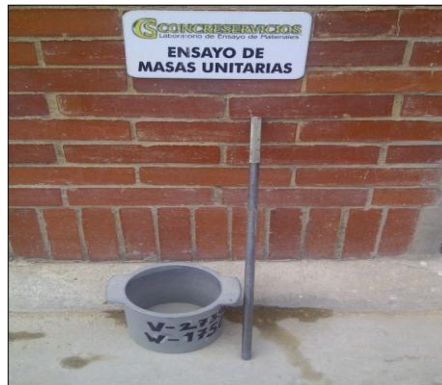
Fotografía 16 Equipo para ensayo de Masas Unitarias
