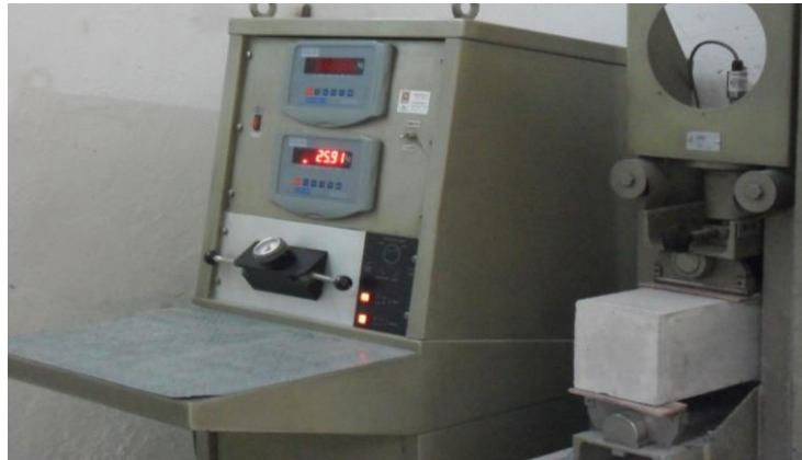
Fotografía 7 Prensa Hidráulica para ensayo de Flexión
