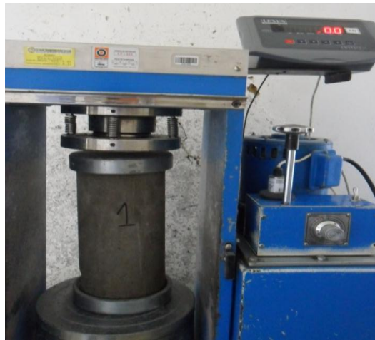
Fotografía 8 Prensa Hidráulica para ensayo de Compresión
