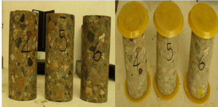
Fotografía 10 Corte y Refrentado de núcleos de concreto
