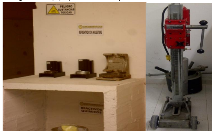
Fotografía 9 Equipo para extracción y refrentado de núcleos de concreto
