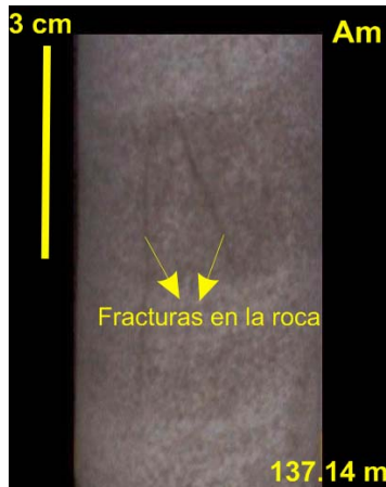
Figura 4.19 Facies Arenita masiva (Am), pozo P-02C . La fotografía corresponde a una cuarzoarenita blanca grisácea de grano fino. En la fotografía se ilustran fracturas presentes en la roca
