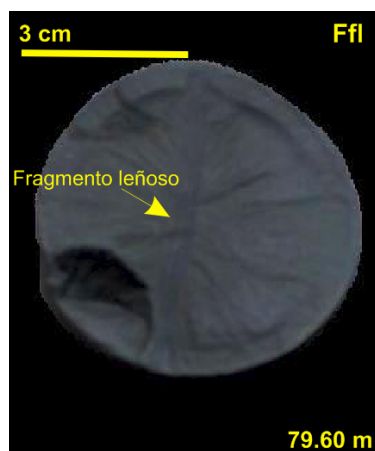
Figura 4.7 Facies Limolita-Arcillolita con fragmentos leñosos (Ffl), pozo P-02C . La fotografía ilustra una arcillolita limosa gris exhibiendo un fragmento laminar de material leñoso
