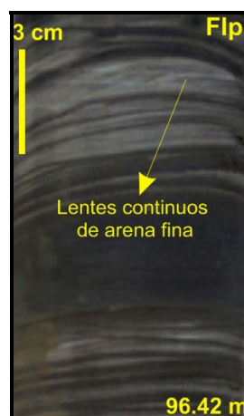
Figura 4.3 Facies Limolita-Arcillolita laminada de paleosuelos (Flp), pozo P-02C . La fotografía ilustra una arcillolita limosa gris exhibiendo laminación lenticular continua
