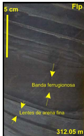
Figura 4.6 Facies Limolita-Arcillolita laminada de paleosuelos (F1p), pozo P-02C . La fotografía ilustra una arcillolita limosa gris exhibiendo laminación lenticular continua y presencia de bandas ferruginosas
