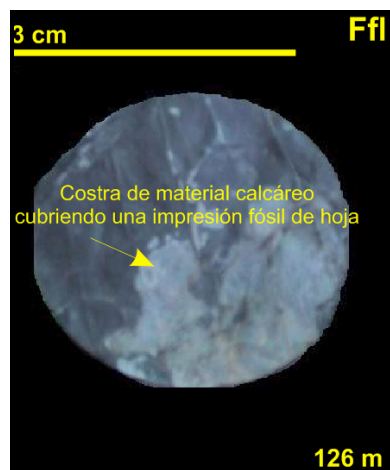
Figura 4.9 Facies Limolita-Arcillolita con fragmentos leñosos (Ffl), pozo P-02C . La fotografía ilustra una arcillolita limosa gris exhibiendo una costra blanca de material calcáreo sobre una impresión fósil de hoja
