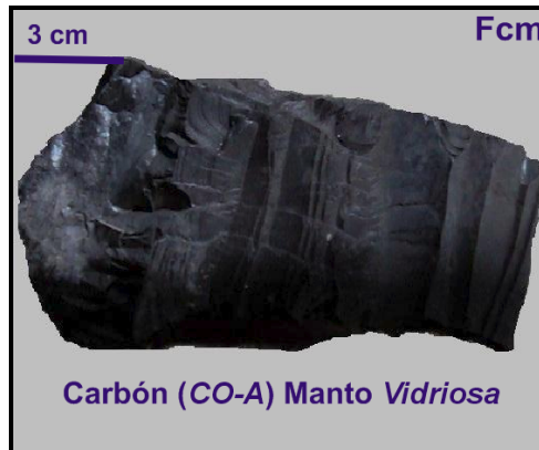
Figura 4.17 Facies Limolita-Arcillolita carbonosa masiva (Fcm), pozo P-02C . La fotografía corresponde a una muestra de carbón CO-A del manto Vidriosa , tomada en el frente inclinado, abscisa 87, de esta mina
