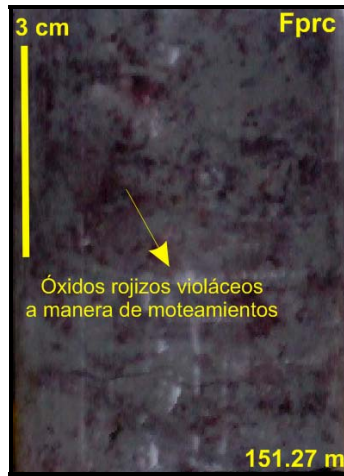
Figura 4.12 Facies Limolita-Arcillolita de paleosuelos con restos carbonosos (Fprc), pozo P-02C . La fotografía corresponde a una arcillolita gris, evidenciando una fuerte presencia de óxidos rojizos violáceos a manera de moteamientos
