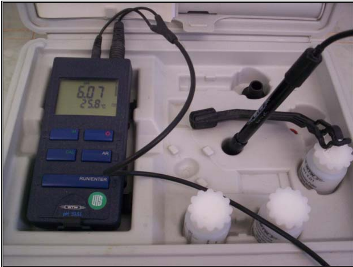
Figura 2. Multiparamétrico WTW 340i, Se determino pH, Eh, Conductividad, Salinidad y Temperatura.
