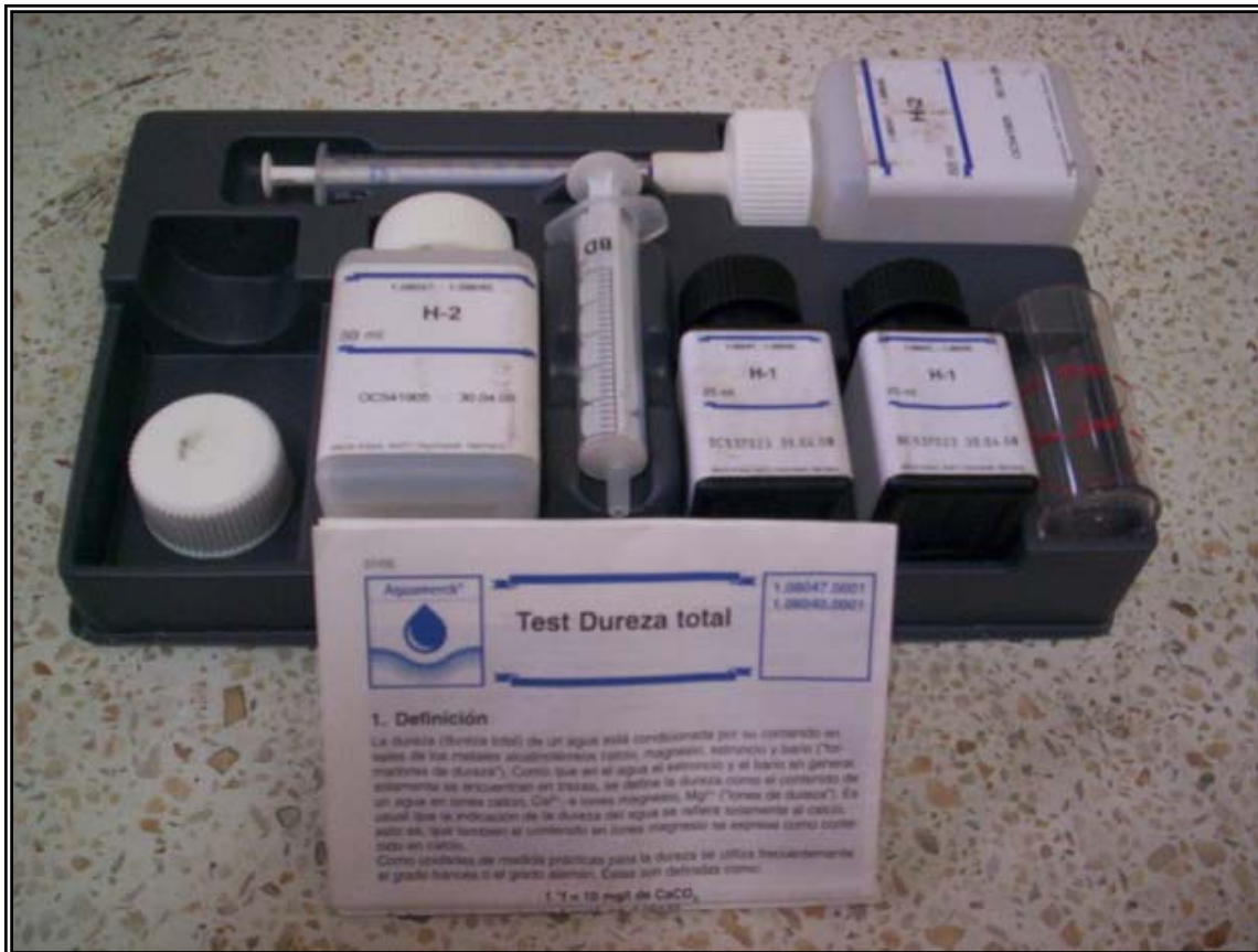
Figura 3. Test de Dureza Total de Aquamerck. Se determino la dureza del agua en campo, por Método Volumétrico.
