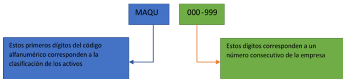
Figura 20. Ejemplo de la codificación para los activos pertenecientes al departamento de Maquinaria y Equipo
