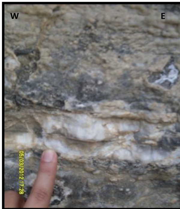
Figura 27. Aspecto, color y textura de la muestra con 32.58% de \text{SO}_3 con coordenadas X=1'244.687 , Y=1'099.157 , Z=733\text{m} \text{E}=10\text{m} .
