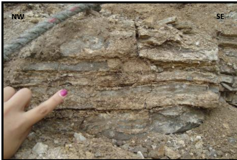
Figura 25. Aspecto, color y textura de la muestra con 3.45% de \text{SO}_3 con coordenadas X= 1'238.734, Y= 1'099.865, Z= 670m \text{E}=10\text{m} .
