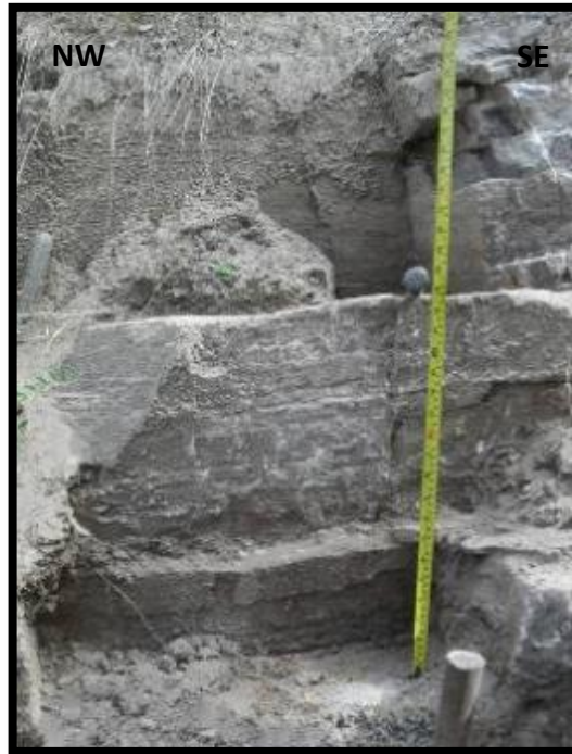
Figura 24. Aspecto, color y textura de la muestra con 30.2% de \text{SO}_3 con coordenadas X= 1'238.757, Y= 1'099.847, Z= 643m \text{E}=15\text{m} .
