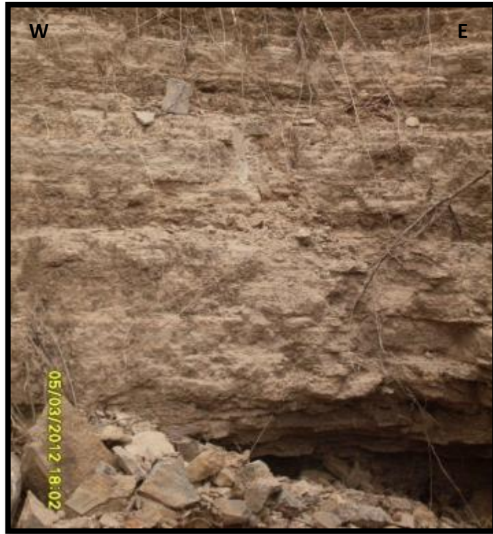
Figura 28. Aspecto, color y textura de la muestra con 0.28% de SO 3 con coordenadas X= 1'244.684, Y= 1'099.550, Z= 736m £=12m.
