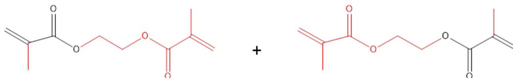
**Figura 4.** Ejemplo de un acrilato multifuncional con dos fragmentos acroleínicos en su estructura. (Izquierda) En color negro los átomos que pertenecen al fragmento acroleínico  $A_i$ , y en rojo los que pertenecen a los sustituyentes. (Derecha) Los átomos en color negro pertenecen al fragmento acroleínico  $A_{i+1}$  y en color rojo los átomos que pertenecen al fragmento acroleínico  $A_{i+1}$ .
