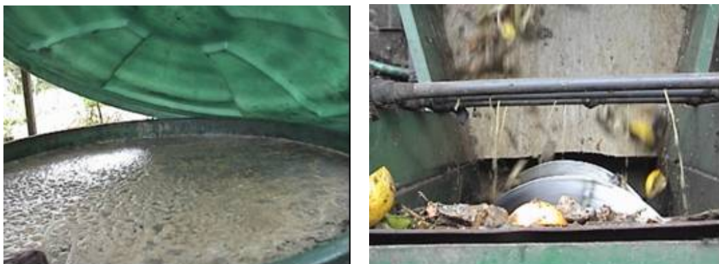
Figura 8. Tanques de almacenamiento de Agropilus y adición a los RSO
