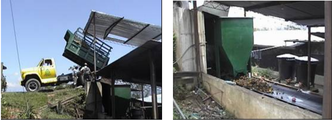
Figura 6. Tolva de recibo y alimentador a banda transportadora.
