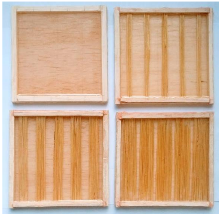
Figura 3. Moldes de los cuatro tipos de probetas fabricadas.
