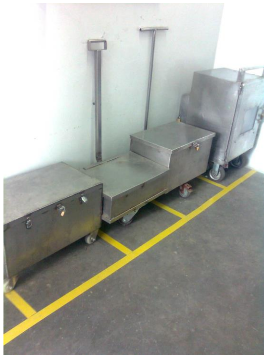
Figura 39. Estrategia de contorno visual para las cajas de herramientas de los técnicos de mantenimiento preventivo taller.
