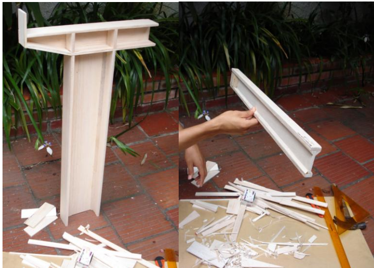
Figura 5.2 Moldes fabricados en balsa.
