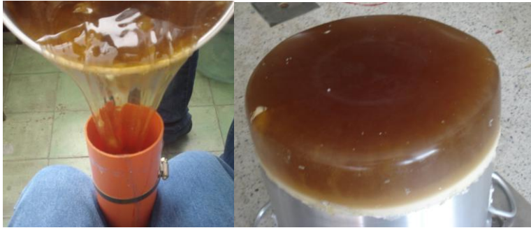
Figura 5.3 Gel de moldeo en estado líquido y sólido.
