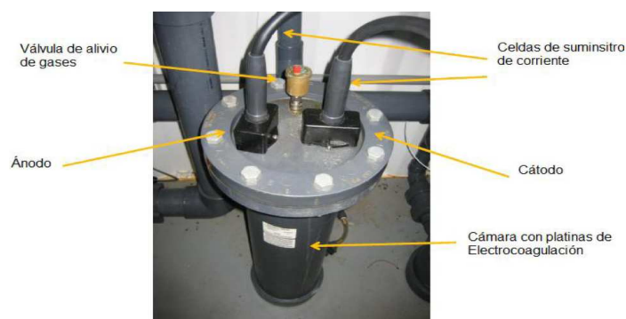
Figura 16 Cámara de Electrocoagulación
