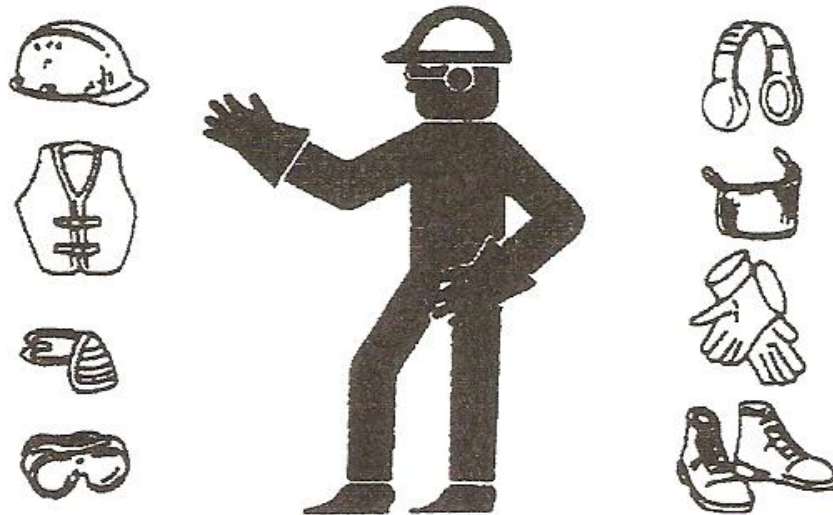
Figura 50. Elementos de protección personal (EPP)
