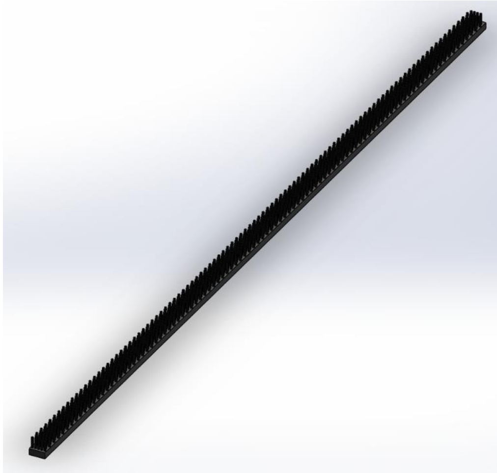
Figura 42. Esquema rascador tipo escobilla
