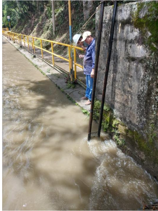
Figura 22. Medición aproximada del flujo másico
